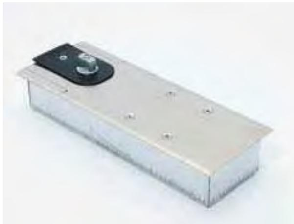
Soltanto 40 mm di prof. per l'incasso, completo di piastra di copertura in acciaio inox. Due posizioni di apertura predefinite e possibilità di regolare la forza di chiusura. Collaudato a norma EN 1154 A.
